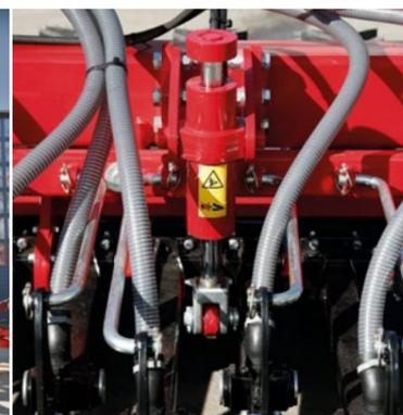
Гидр. бесступенчатая регулировка давления сошников
