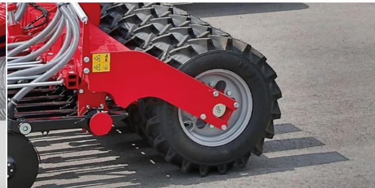
Сплошной колесный почвоуплотнитель
